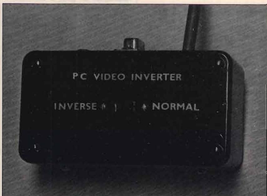
gini sullo schermo sia via software sia via hardware: nel primo caso si ricorre al *driver* ANSI.SYS del MS/PC-DOS, nel secondo a un dispositivo come quello descritto in questo articolo.
